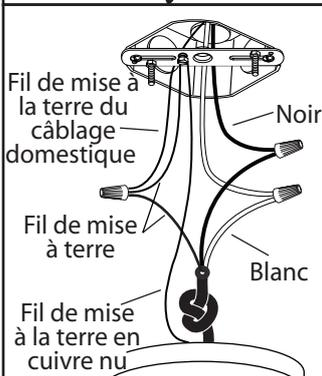
4. Vissez fermement le fil de la mise à terre (cuivre nu) sur le luminaire à la vis de mise à terre sur la ferrure de montage (en le tournant tout autour de la vis de mise à terre) puis en le branchant au fil de mise à terre de la maison avec une marquette. Posez le fil noir de la boîte électrique au deux fils noir de la fixture. Posez le fil lanc de la boîte électrique au deux fils blanc de la fixture.
