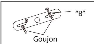
1. Dévissez l'écrou B. Ajustez le poteau à la longueur désirée et barrez en place avec cet écrou.
