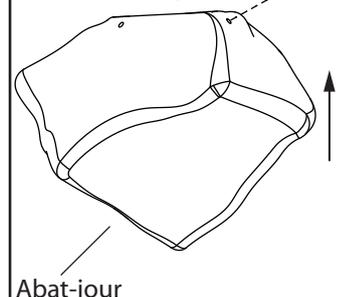
8. Retirer les vis à doigt qui sont sur le luminaire. Posez l'abat-jour sur la fixture à l'aide de vis à doigt (surrez seulement qu'au doigt).
