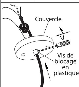
3. Ajuster la longueur du cordon flexible. Serrez la vis de blocage en plastique un fois la longueur obtenue. Par précaution, ne défaites pas le noeud à l'intérieur du anopé.
