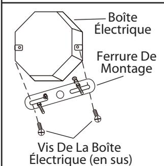
2. Posez la ferrure de montage à la boîte électrique à l'aide des vis de la boîte électrique (en sus). Assurez-vous que les goujons de la ferrure d'installation font face vers l'extérieur de la boîte électrique.
