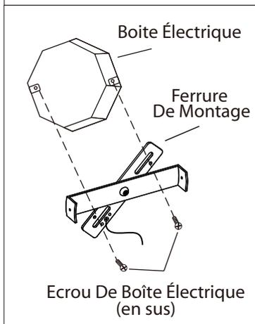
2. Posez la ferrure d'installation à la boîte de sortie électrique à l'aide des vis de la boîte (en sus).
