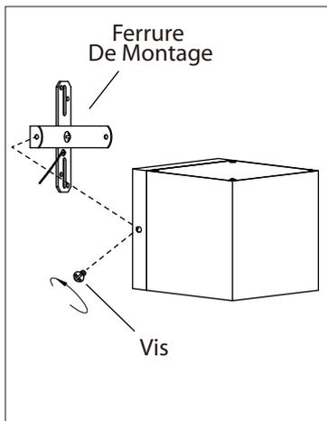
1. Retirer la ferrure d'installation du luminaire en retirant les 2 vis.
