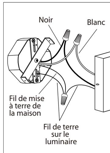
3. Branchez les fils de la mise a terre (cuivre nu ou vert) de votre montage au fil de la mise A terre (cuivre nu ou vert) ou vis de la mise a terre dans la boîte électrique. Posez le fil noir de la fixture au fil noir dans la boîte électrique et posez le fil blanc de la fixture au fil blanc dans la boîte.
