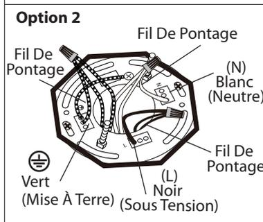
**Option 2:** Lorsqu'il y a des multiples de fils dans la boîte électrique, vert (mise à terre), noir (sous tension), blanc (neutre), poser seulement qu'un de chaque fil soit vert, noir et blanc avant pour la connexion. Retirez 7mm de la gaine d'un fil de pontage de 6" inclus. Posez (poussez) les fils dans les insertions appropriées.
