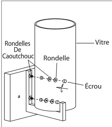
**1.** Sécurisez le verre au luminaire avec les rondelles, rondelles en caoutchouc et écrou.
