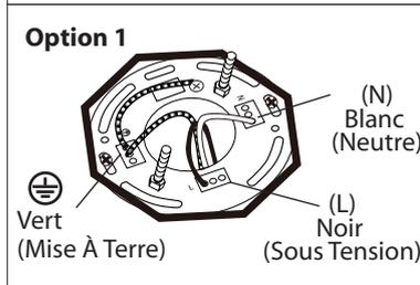
**3. Option 1:** Poussez pour brancher les fils de la boîte électrique (courant de la maison) dans les insertions appropriées.
