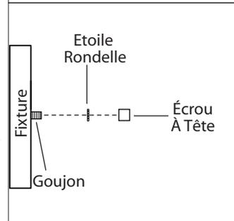
**5.** Poussez délicatement les fils à l'intérieur de la boîte électrique et placez le luminaire sur les goujons sur la ferrure de montage. Serrez le luminaire en place à l'aide des écrous étoilés et les écrous à capuchon.
