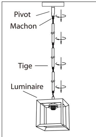
1. Installez la longueur de colonne requise en faisant passer le fil dans la colonne puis en vissant la colonne sur le luminaire. Installez le pivot sur la colonne en vous assurant que le manchon est au niveau du pivot.
