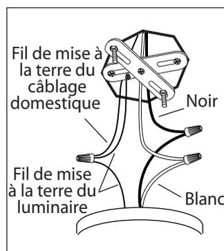
4. Branchez les fils de la mise a terre (cuivre nu ou vert) de votre montage au fil de la mise a terre (cuivre nu ou vert) ou vis de la mise a terre dans la boîte électrique. Posez le fil noir de la fixture au fil noir dans la boîte électrique et posez le fil blanc de la fixture au fil blanc dans la boîte.
