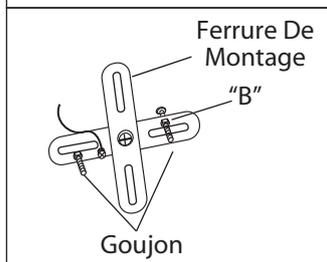
2. Dévissez l'écrou B. Ajustez le poteau à la longueur désirée et barrez en place avec cet écrou.
