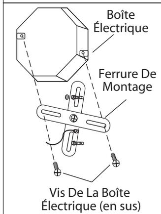
3. Posez la ferrure de montage à la boîte électrique à l'aide des vis de la boîte électrique (en sus). Assurez-vous que les goujons de la ferrure d'installation font face vers l'extérieur de la boîte électrique.
