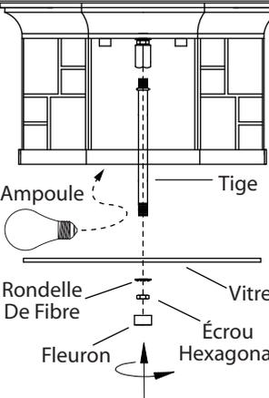
3. Branchez (poussez) les fils électriques du luminaire dans les insertions appropriées. Noir (sous tension), Blanc (neutre), vert (mise à terre)
